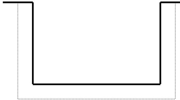
Si el terreno tiene poca cohesión será necesario apuntalar las paredes a medida que se abre la zanja.
